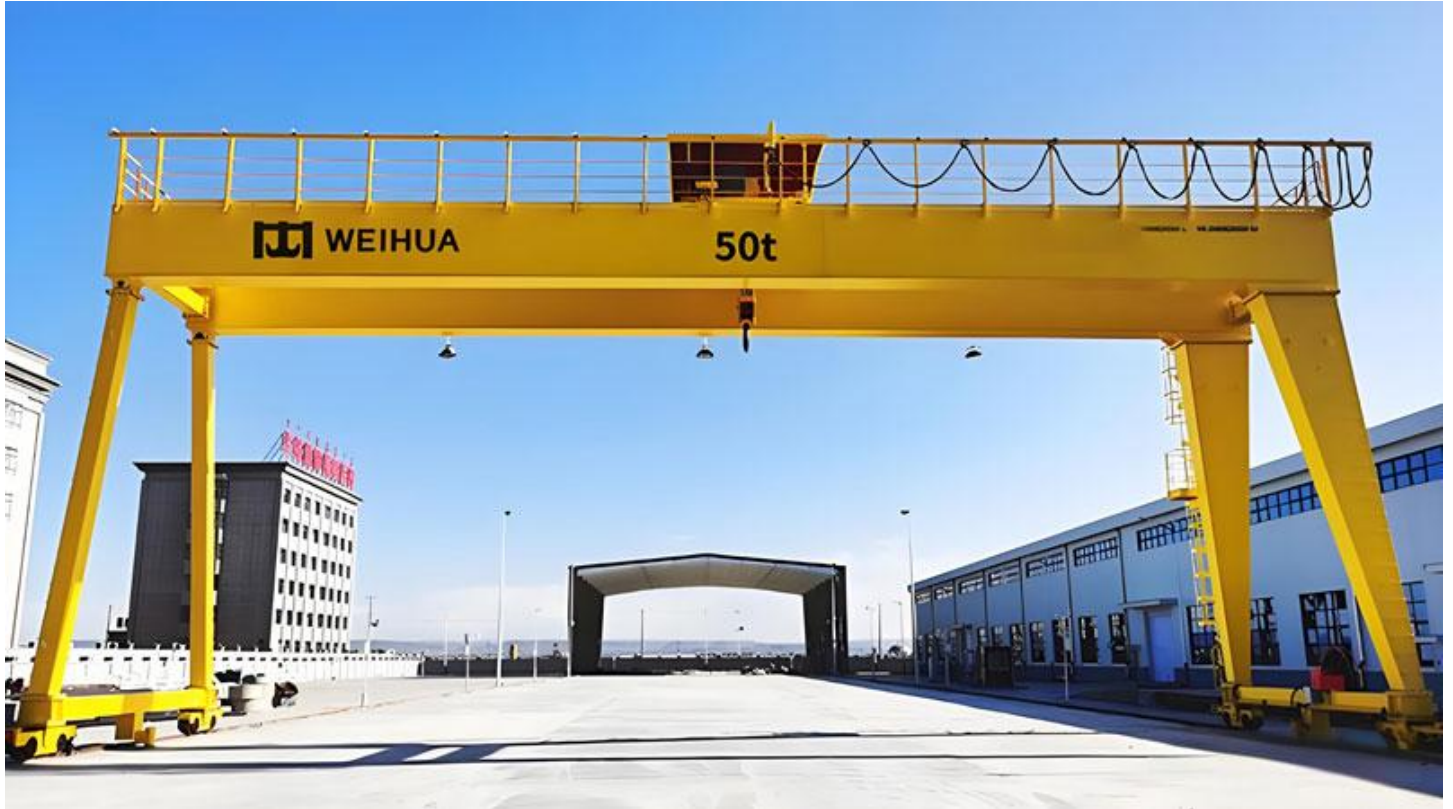
Grúa RMG de doble viga de 50 toneladas
