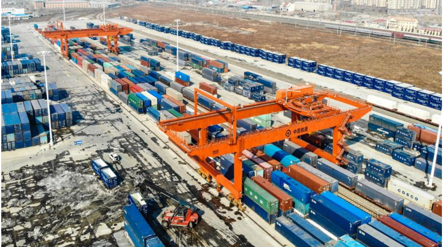
Grúa para contenedores RMG
