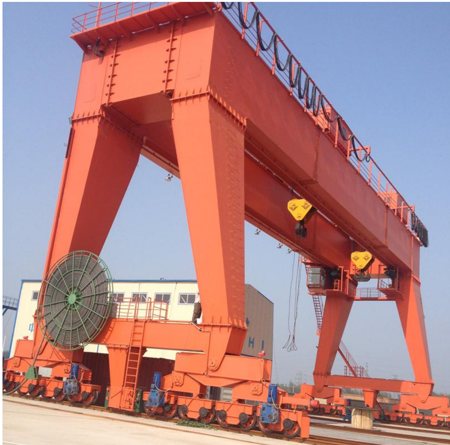
Grúa Pórtico de Dos Vigas
