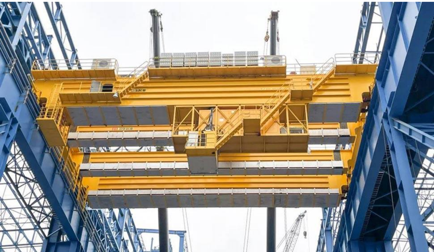
Grúa Puente de 100 Toneladas
