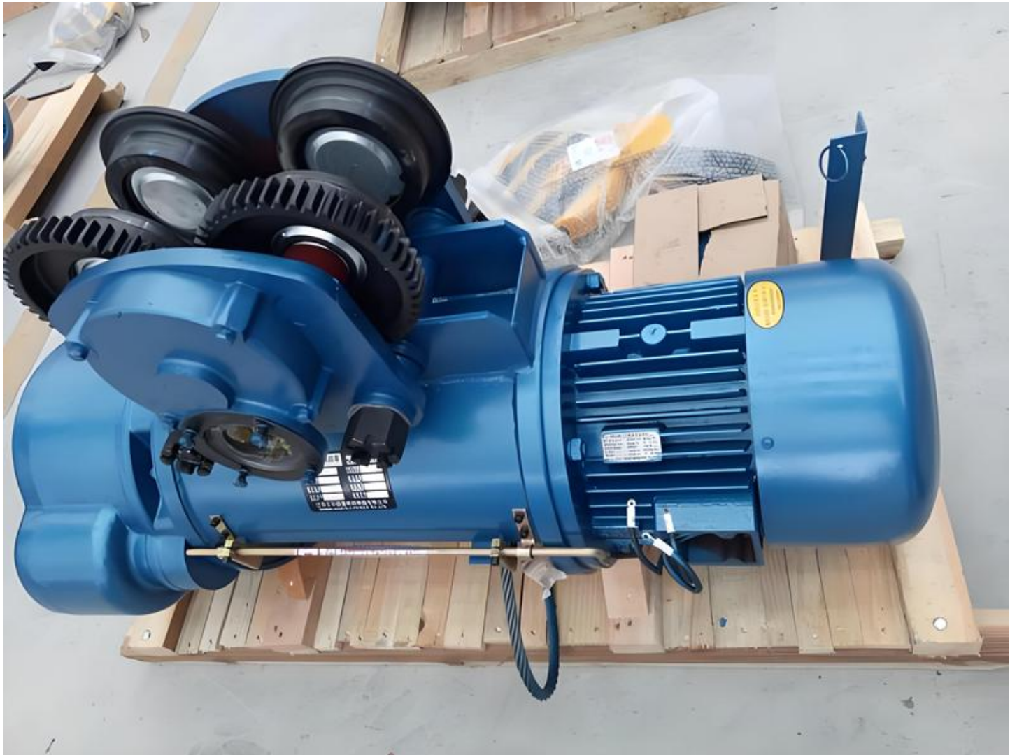
Polipasto eléctrico de 16 toneladas
