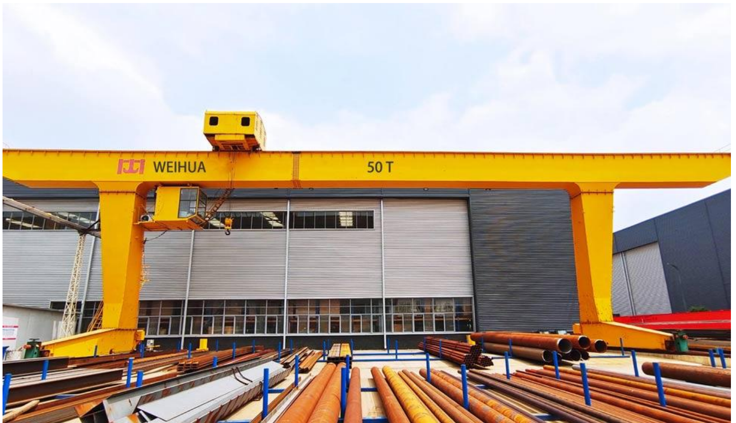
grúa pórtico monorraíl de 50 toneladas
